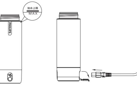
**通电:** 接入电源进入待机状态,发出一声“滴”,同时按键亮蓝光,15秒后显示实时温度,如果1分钟内无操作,则进入待机模式被按键锁定,长按按键2秒即可解除待机模式。
