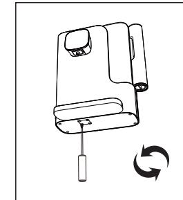
第二步：用十字螺丝刀松开滤网上的螺丝，并取出滤网。
