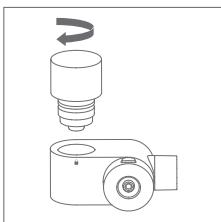
(2) 将装有适配器的龙头插入龙头过滤器快接连接螺母内，并确保安装到位。
