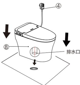
将陶瓷排水口对准PVC排水管，用力下压，至一体机的陶瓷与地面平齐。
