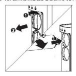
⑤ 恢复净水机的电源,打开鹅颈龙头开关, 净水流出。如有更换反渗透膜滤芯,前 30分钟的出水,请勿使用。如仅更换其 它滤芯,前10分钟的出水,请勿使用。
