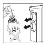
● 请保持废水管的出水通畅,以免造成净水机滤芯或者内部元器件损坏。
