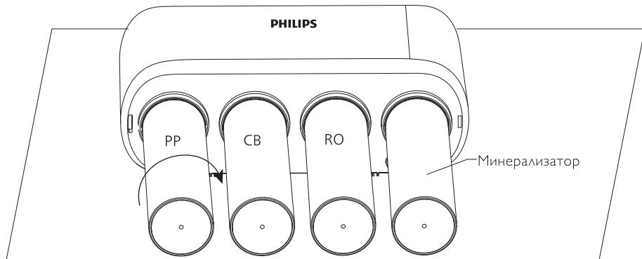
e. Включите трехходовой шаровой кран и смеситель. Сливайте воду в течение 1,5 часов, чтобы промыть новые фильтры.
