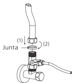
e. Cierre la válvula de bola de tres vías. Active el suministro de agua fría. Limpie las conexiones con un pañuelo de papel para ver si hay fugas. Si el pañuelo permanece seco, significa que la válvula de bola de tres vías está instalada correctamente.
