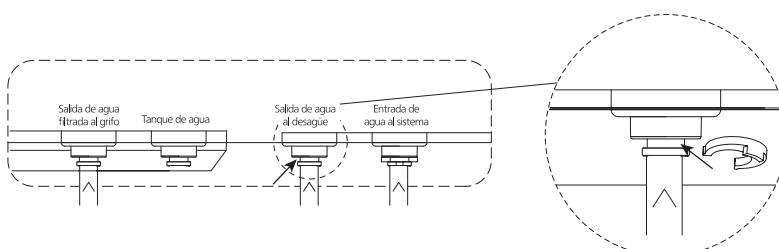
Nota: La presión del agua de entrada debe estar entre 0,3 y 0,7 MPa. Si la presión es demasiado baja, se debe instalar un reforzador de presión antes del sistema. Si la presión es demasiado alta, se debe instalar una válvula de descarga de presión antes del sistema.
