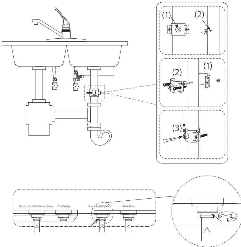
Примечание: Давление воды на входе должно быть в пределах 0,3-0,7 МПа. Если давление слишком низкое, перед системой следует установить усилитель давления.
