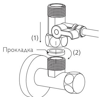
д. Соедините шланг холодной воды с трехходовым шаровым краном и плотно закрутите гаечным ключом.
