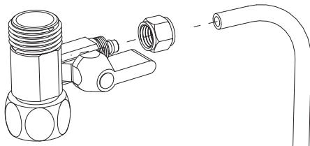
c. Installare la valvola a sfera a tre vie sulla valvola dell'acqua fredda. Non dimenticare di inserire la guarnizione nella valvola a sfera a tre vie durante l'installazione.
