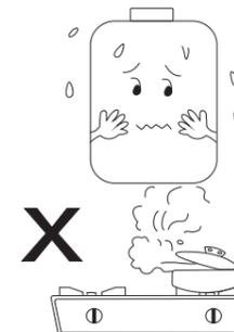
● 严禁安装在电气设备或有易燃品（如汽油、有机溶剂、胶水）及腐蚀性化学药品（如酒精、盐酸、硫磺等）旁边，以防发生火灾或腐蚀机体。
