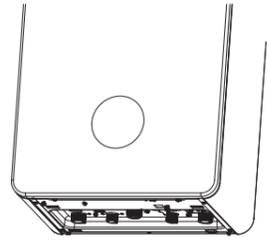
请定期清洗滤网组合，以免水杂质堵塞滤网组合，造成机器无法启动。
