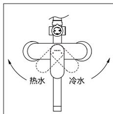
(3) 转动功能切换把手, 当对应的图标朝上时相应图示位置出水, 如下图所示。
