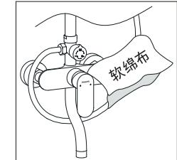
！ 请定期清洗顶喷花洒进水口、手持花洒软管进水接头、内滤网垫片以防止水量不足。
