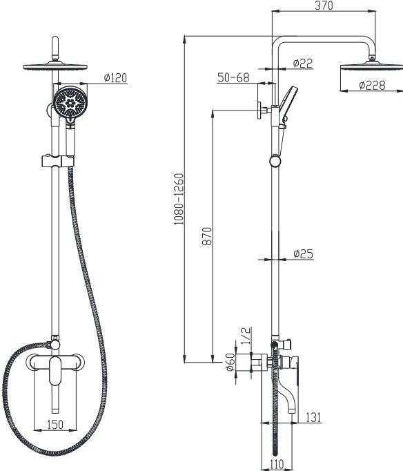
(2) 通水清除供水管路内的杂质及污泥，然后在曲脚上缠足生料带后旋入供水管道接头内，需保证安装后的曲脚间距 150mm且水平及高度齐平。
