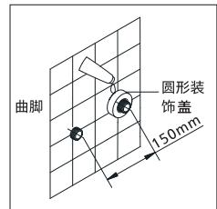
(3) 将圆形装饰盖旋在曲脚上，贴紧墙面。再将橡胶垫片放入龙头进水端六角螺母内后与曲脚旋紧固定。
