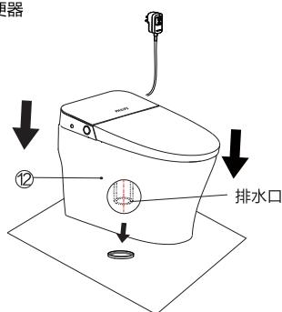
将陶瓷排水口对准PVC排水管，用力下压，至一体机的陶瓷与地面平齐。
