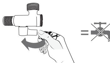
**A 第一步：拔出电源插头，关闭进水阀开关。**
