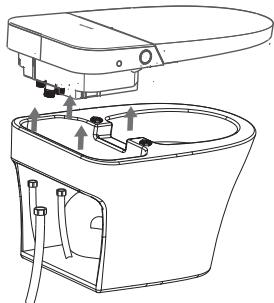
**C 第三步：按电子盖后面的螺母，给内部排水。**
