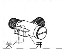
调节进水阀开关，使产品在合适水量下工作。顺时针方向降低水量，逆时针方向增加水量。
