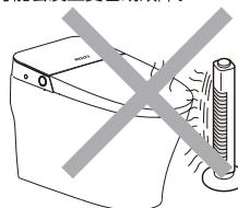
请勿在产品倾斜、倒置等非水平安装状况下接通电源。
