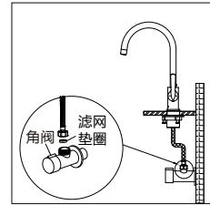
(4) 通水观察3-5分钟, 检查确认各连接处无泄漏后方可正常使用。
