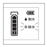
(4) 缺水圖示: 當淨化水流量過低時(表示濾芯可能要更換), " 缺水"圖示閃爍顯示。
