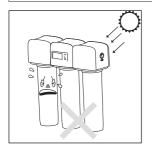
淨水器切勿安裝在陽光直射的地方或暴露於含有有害化學品的 地方,或有掉落,被撞擊等可能受到損害的任何地方。
