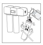
● 清潔時,請勿將其它液體倒入濾芯,以免濾芯過濾系統損壞。
