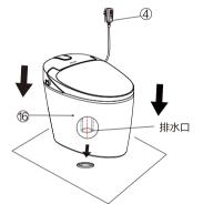
将陶瓷排水口对准PVC排水管,用力下压,至一体机的陶瓷与地面平齐。 注意:安装前请保持地面整洁与干燥。
