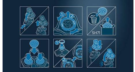
1. 按下释放按钮并拆下剃须刀头支架。2. 逆时针旋转固定环, 将其取下。3. 取出旧剃须刀头, 然后插入替换刀头 (槽口应正好插入凸起部位)。
