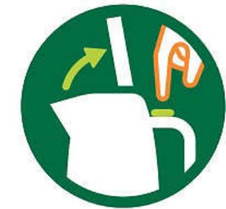
Der Deckel öffnet sich ganz einfach per Knopfdruck, sodass jeglicher Kontakt mit Dampf verhindert wird. Die große Öffnung erleichtert die Reinigung.
