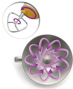
Das Mixen mit Planetengetriebe ermöglicht den Werkzeugen zum Kneten, Mixen und Rühren, sich in einer einzigartigen Rückwärts- und Vorwärtsbewegung statt in einer einfachen Kreisbewegung zu bewegen. So werden alle Bereiche der Schüssel erreicht und die Zutaten gut durchmischt.
