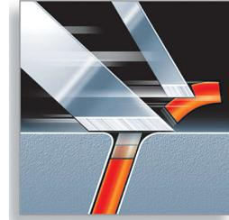
Das 2-Klingen-System dieses Elektrorasierers hebt die Haare an und schneidet sie direkt für eine sanftere Rasur an der Hautoberfläche ab.
