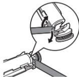
8. 充電電池をハンドル内部部品から引き出し、もう一方の充電電池タブを壊します。
