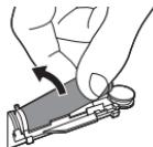
5. 充電池と内部部品の底の黒い枠との間にマイナスドライバーの先を入れ、こじ開けて充電池を離し、黒い枠を壊します。
