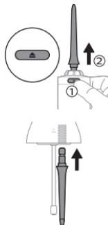
3. ハンドルの底部にノズルの底部を挿入します。
