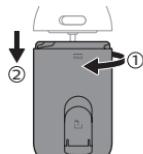
2. ハンドルの後ろにあるノズル取り外しボタンを押して、ハンドルからノズルを取り外します。
