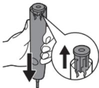
5. 充電電池と内部部品の底の白い枠との間にマイナスドライバーの先を入れ、こじ開けて充電電池を離し、白い枠を壊します。
