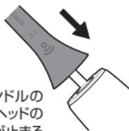
ブラシヘッドの毛先がハンドルの正面を向くように、ブラシヘッドの向きをそろえ、ブラシヘッドが止まるまで金属シャフトにヘッドをしっかり差し込んで取り付けます。
