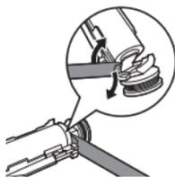
7. 充電電池をハンドル内部部品から引き出し、もう一方の充電電池タブを壊します。
