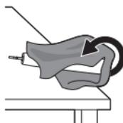
3. 片手でハンドルの上部を持ち、ハンドルの底から1.5cmの位置をハンマーで叩きます。ハンドルを回転させながら、四方向から強く叩いて底のキャップを外します。
