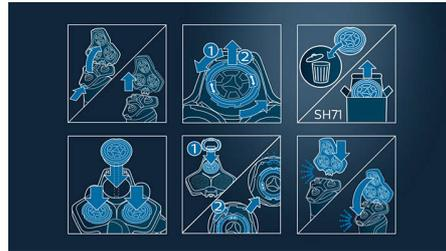
1. Drücken Sie die Entriegelungstasten und nehmen Sie den Scherkopf ab. 2. Drehen Sie die Ringe gegen den Uhrzeigersinn und entfernen Sie sie. 3. Entfernen Sie die alten Scherköpfe und setzen Sie die Ersatz-Scherköpfe ein (die Führungen sollten genau auf die Vorsprünge passen). 4. Setzen Sie die Ringe wieder auf und drehen Sie sie im Uhrzeigersinn, bis sie hörbar einrasten. 5. Setzen Sie den Scherhalter wieder ein und schließen Sie ihn.
