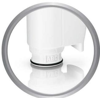
Le impostazioni del filtro dell'acqua possono essere regolate in base alla durezza dell'acqua. Basta ruotare l'anello regolabile sul filtro dell'acqua di Intenza+, impostandolo su A per le aree con acqua dolce, su B per una durezza media dell'acqua (impostazione predefinita) o C per un'acqua dura. Questo assicurerà una
