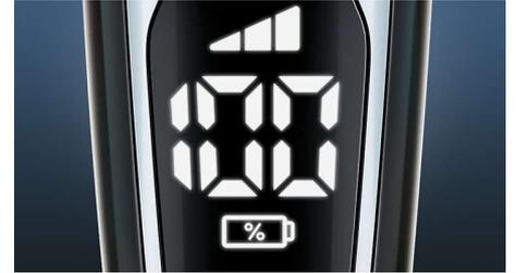
L'écran intuitif affiche des informations pratiques vous permettant d'obtenir des performances optimales : - Indicateur de charge à 3 chiffres (%) - Voyant de nettoyage - Voyant de batterie faible - Voyant de remplacement des têtes - Voyant de verrouillage
