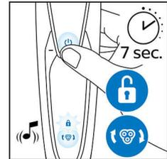
Depois de substituir as cabeças de corte, pode repor o lembrete de substituição, premindo o botão ligar/desligar durante mais de 7 segundos. Caso contrário, o aviso de substituição desligar-se-á automaticamente depois de 9 utilização consecutivas.
