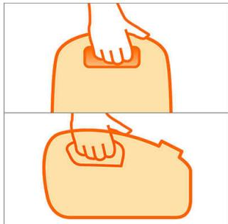
L'aspirapolvere è dotato di una maniglia anteriore e una sulla parte superiore per trasportarlo facilmente prima, durante e dopo l'uso.
