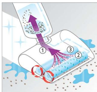
Tehnologija Triple-Acceleration istovremeno obavlja tri akcije čišćenja: – Ciklonsko usisavanje: učinkovito usisava prašinu i slobodnu prljavštinu – Vlažno brisanje: prva četka koja se brzo okreće učinkovito uklanja mrlje i prolivene tekućine – Sušenje: druga četka koja se brzo okreće upija preostalu vodu, smanjujući vrijeme sušenja za do 50%\*
