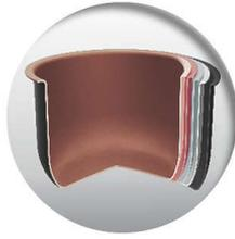
內鍋厚度由底部的 6.0 毫米漸漸變成頂部的 2.0 毫米，能夠從底部的主加熱器配件均勻傳熱至內鍋的頂部。五層黃金內鍋能夠有效地均勻傳熱
