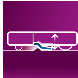
吸塵機器人搭載可移動式吸嘴，能依循地面、地毯、地墊等輪廓移動，達到精確清潔效果。
