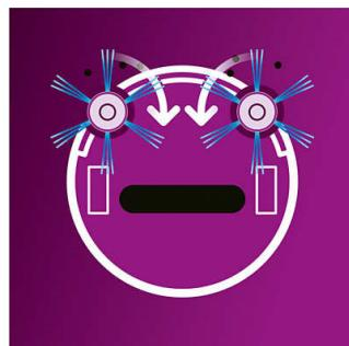
首先，兩柄長刷將髒汙及灰塵掃入機器人的行進路徑。接著，吸嘴和強力馬達會將髒汙及灰塵完全吸入。最後，一按即用拖淨清潔墊會帶走地板上最細微的灰塵，讓居家環境無比乾淨。
