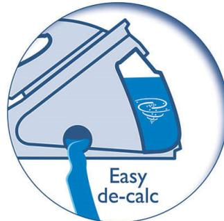
Izuzetno dugotrajne radne značajke parnog glačanja: ekskluzivna funkcija Easy De-Calc tvrtke Philips produžuje vijek trajanja glačala s generatorom pare, a idealna je za uklanjanje kamenca. Zvučnim i svjetlosnim podsjetnikom glačalo će vas podsjetiti da ga trebate očistiti. Jednostavno otvorite gumb Easy De-Calc kada je aparat hladan i pokupite vodu s prljavštinom i kamencem u čašu.
