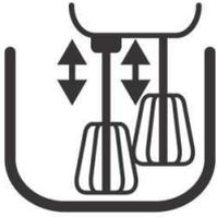
La función FlexiMix permite que las varillas batidoras se muevan hacia adentro y hacia afuera durante su uso, lo que permite actuar fácilmente incluso en la masa más dura.
