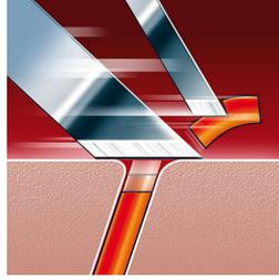
電鬚刨的雙層刀片系統可將皮膚深層的鬚鬚提起並舒適地剃去。
