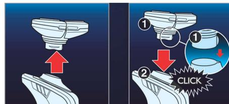
使用接上和除下開關系統可輕鬆替換剃鬚刀頭組件。
