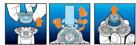
1. 拉出剃鬚刀頭固定器。2. 更換剃鬚刀頭。3. 重新安上剃鬚刀頭固定器。4. 長按開 / 關按鈕 5 秒以重設電鬚刨。
