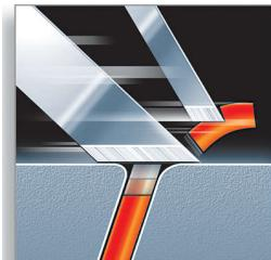
電鬚刨的雙層刀片系統可將皮膚深層的鬍鬚提起並舒適地刮去。
