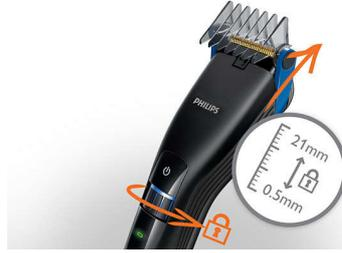
Drehen Sie das Zoom-Wheel, um Ihre gewünschte Länge einzustellen. Der anpassbare Kamm bietet Schnittlängen von 3 mm bis zu 21 mm mit genau 1 mm Abstand zwischen den einzelnen Längeneinstellungen. Sie können das Gerät auch ohne Kammaufsatz verwenden, um auf eine Länge von 0,5 mm zu trimmen.
