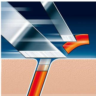
飛利浦電鬚刀的雙刀鋒系統：第一排刀鋒提起鬚鬚，第二排刀鋒舒適而乾淨地刮除鬚鬚。
