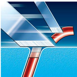
Система сдвоенных лезвий электробритвы поднимает волосы для комфортного бритья на уровне кожи.
