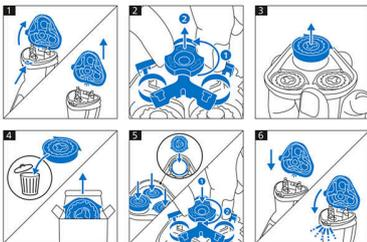
1. Ouvrez le rasoir en appuyant sur le bouton de déverrouillage. 2. Retirez la fixation en faisant tourner le système de verrouillage dans le sens
