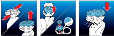
1. Appuyez sur les boutons de déverrouillage situés sur l'unité de rasage et retirez le support pour têtes de rasage de l'unité de rasage. 2. Tournez les bagues de fixation dans le sens contraire aux aiguilles d'une montre
