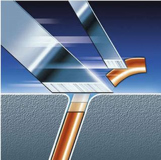
Sistem pisau ganda dari pencukur listrik ini mengangkat rambut untuk mencukurnya dengan aman di bawah lapisan kulit.
