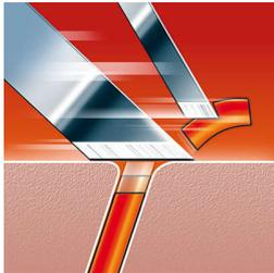
O sistema de lâmina dupla incorporado desta máquina de barbear eléctrica levanta os pêlos para os cortar, de forma confortável, abaixo do nível da pele.
