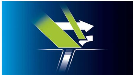
O sistema de lâmina dupla incorporado nas nossas máquinas de barbear eléctricas levanta os pêlos para cortar o pêlo, de forma confortável, abaixo do nível da pele, proporcionando um barbear mais rente
