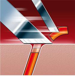
Le système à double lame de ce rasoir électrique redresse les poils afin de les couper au plus près.
