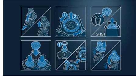
1. Drücken Sie die Entriegelungstasten und nehmen Sie den Scherkopf ab.
