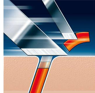
Système à double lame du rasoir Philips : la première lame soulève le poil, la seconde le coupe pour un rasage agréable et précis.
