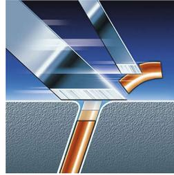
Das 2-Klingen-System dieses Elektrorasierers hebt die Haare an und schneidet sie direkt für eine sanfte Rasur an der Hautoberfläche ab.
