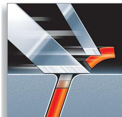
Система сдвоенных лезвий электробритвы поднимает волоски для комфорtnого бритья на уровне кожи.
