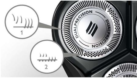
Лезвия DualPrecision обеспечивают максимально комфортное бритье как длинных волос, так и щетины: 1. Прорези срезают длинные волосы. 2. Отверстия сбривают короткую щетину.
