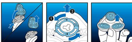
1. Откройте бритву с помощью кнопки отсоединения. 2. Снимите удерживающие кольца, повернув их против часовой
